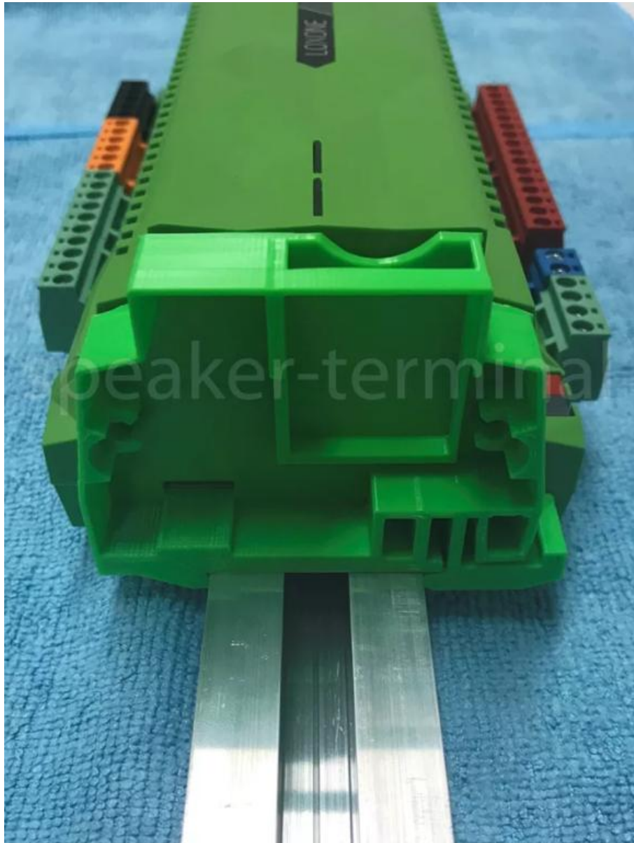
SD Karten Adapter neben dem Miniserver auf der Hutschiene montieren, sodass er direkt neben dem Miniserver und der SD Karten Öffnung zu liegen kommt.
